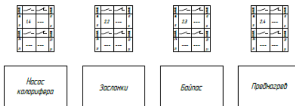
Рис.16(6) Схема электрическая принципиальная Geniox TX 25
