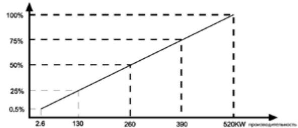
Энергопотребление при использовании модульной системы с регулируемым компрессором
